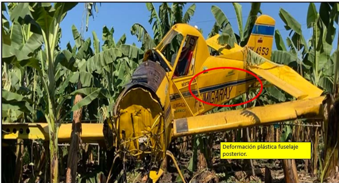
Fotografía No. 4: Daños fuselaje lateral inferior trasero.
