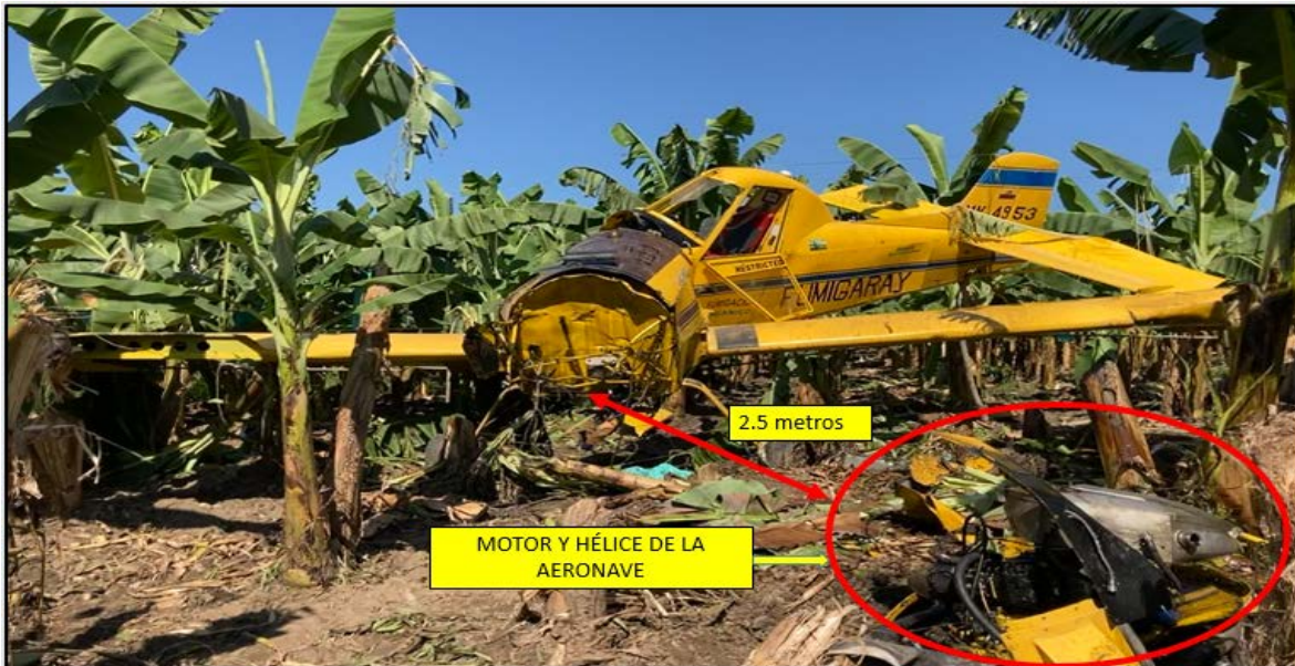
Fotografía No. 3: Desprendimiento del motor y de la hélice.
