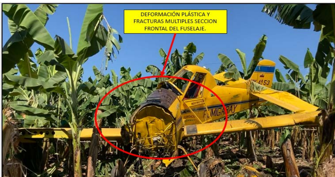
Fotografía No. 2: Daños sustanciales en la parte frontal del fuselaje.
