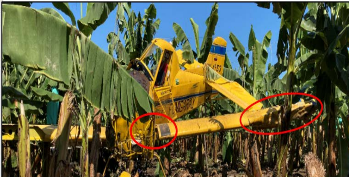
Fotografía No. 5: Desprendimiento del plano izquierdo y múltiples golpes en el borde de ataque.
